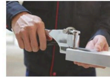
فحص الصلابة الإنشائية Hardness inspection
