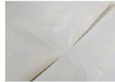
اختبار التقشير واللحام لـ PVC Peeling test after hot-welding
