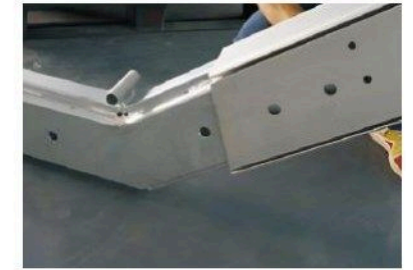
فحص وصلات الربط والتجميع Connector fitting checking
